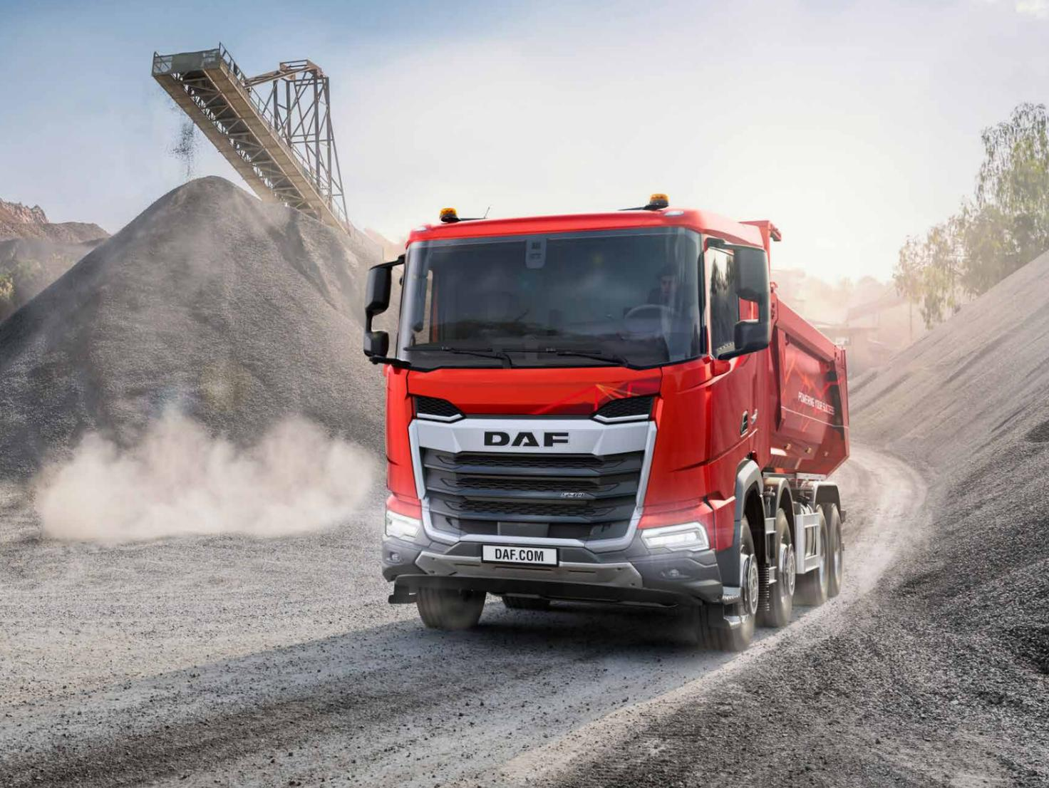
El robusto parachoques de acero de 3 piezas y la placa de protección del radiador son muy resistentes y reducen el riesgo de daños en los componentes más vulnerables situados en la parte delantera del vehículo. El parachoques también incluye cuatro luces LED de serie: dos para las luces de carretera y dos para las luces antiniebla.
